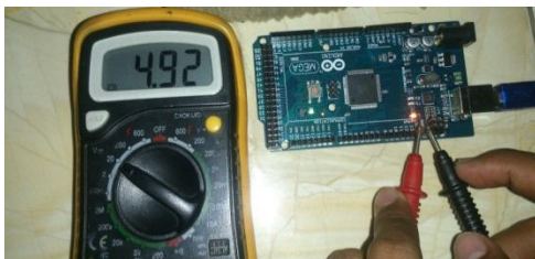
Gambar 17. Pengukuran Pin Digital
