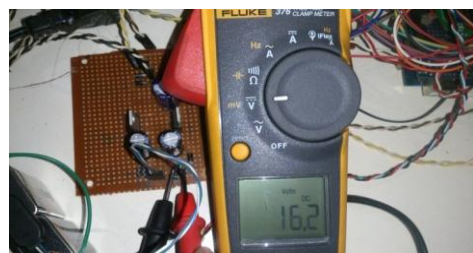
Gambar 16. Pengukuran Power Supply menggunakan Baterai
