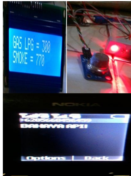
Gambar 21. Pengujian Sensor MQ-2 (Asap)
