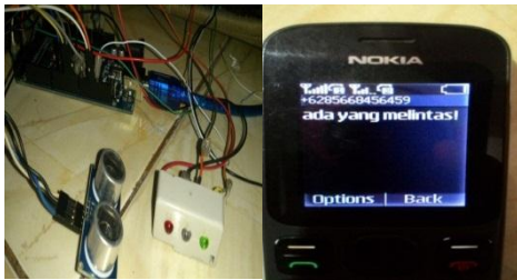
Gambar 18. Rangkaian Sensor Ultrasonik
