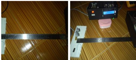
Gambar 19. Pengujian menggunakan penggaris (kiri) dan pengujian sensor PING menggunakan sensor dan Arduino Uno (kanan).
