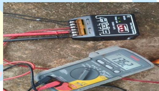
Gambar 15: Pengujian BCC Tegangan Output Menuju Baterai
