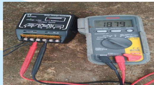
Gambar 14: Pengujian BCC tegangan Input Solar panel
