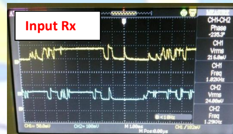
Gambar 5. Hasil input RX dengan osiloskop jarak 1 m
