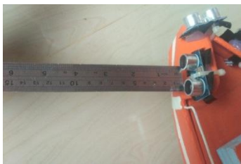
Gambar 13. Pengujian sensor ultrasonik disebelah kiri
