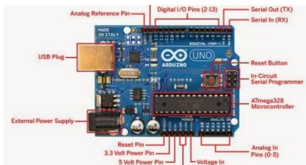
Gambar 2. Arduino UNO ( Sumber : arduino.cc )
