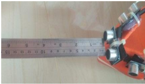
Gambar 16. Pengujian sensor ultrasonic didepan
