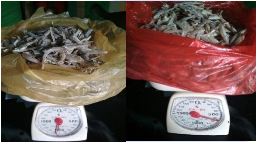
Gambar 23. Hasil dari penjemuran dengan matahari (kiri) Hasil pengeringan menggunakan perangkat (kanan)
