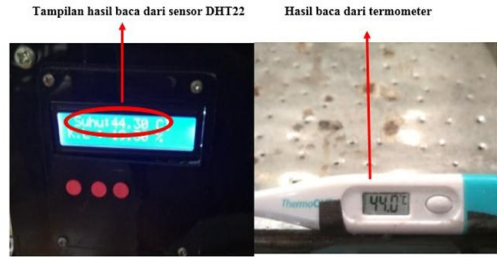
Gambar 17. Suhu ruangan dapat merata kebawah ditunjukkan pada LCD dan termometer sebagai acuan
