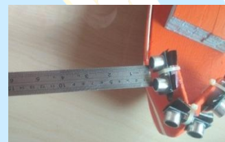
Gambar 33. Pengujian sensor ultrasonik dibagian sebelah kanan kapal
