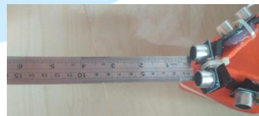
Gambar 29. Pengujian sensor ultrasonik dibagian depan kapal
