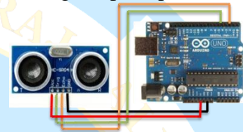
Gambar 18. Perancangan sensor ultrasonik dibagian sebelah kanan kapal
