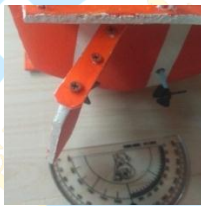
Gambar 30. Motor servo memutar kemudi kesebelah kanan kapal
